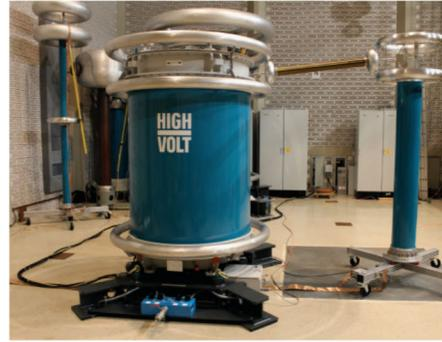
Abb. 36: Wechselspannungsprüfanlage (links), Gleichspannungsprüfanlage (rechts)
