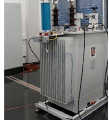
Abb. 34: Resonanzprüfanlage
