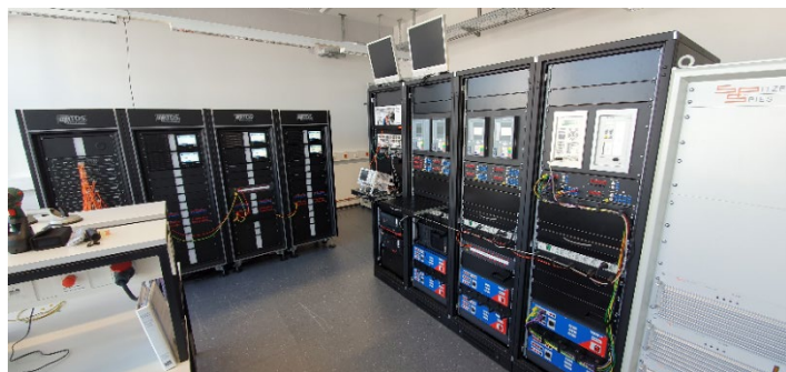
RTDS Simulator (hinten) und HIL Racks mit weiteren Simulatoren, Schutzgeräten, Messverstärkern und Steuerungsrechnern
